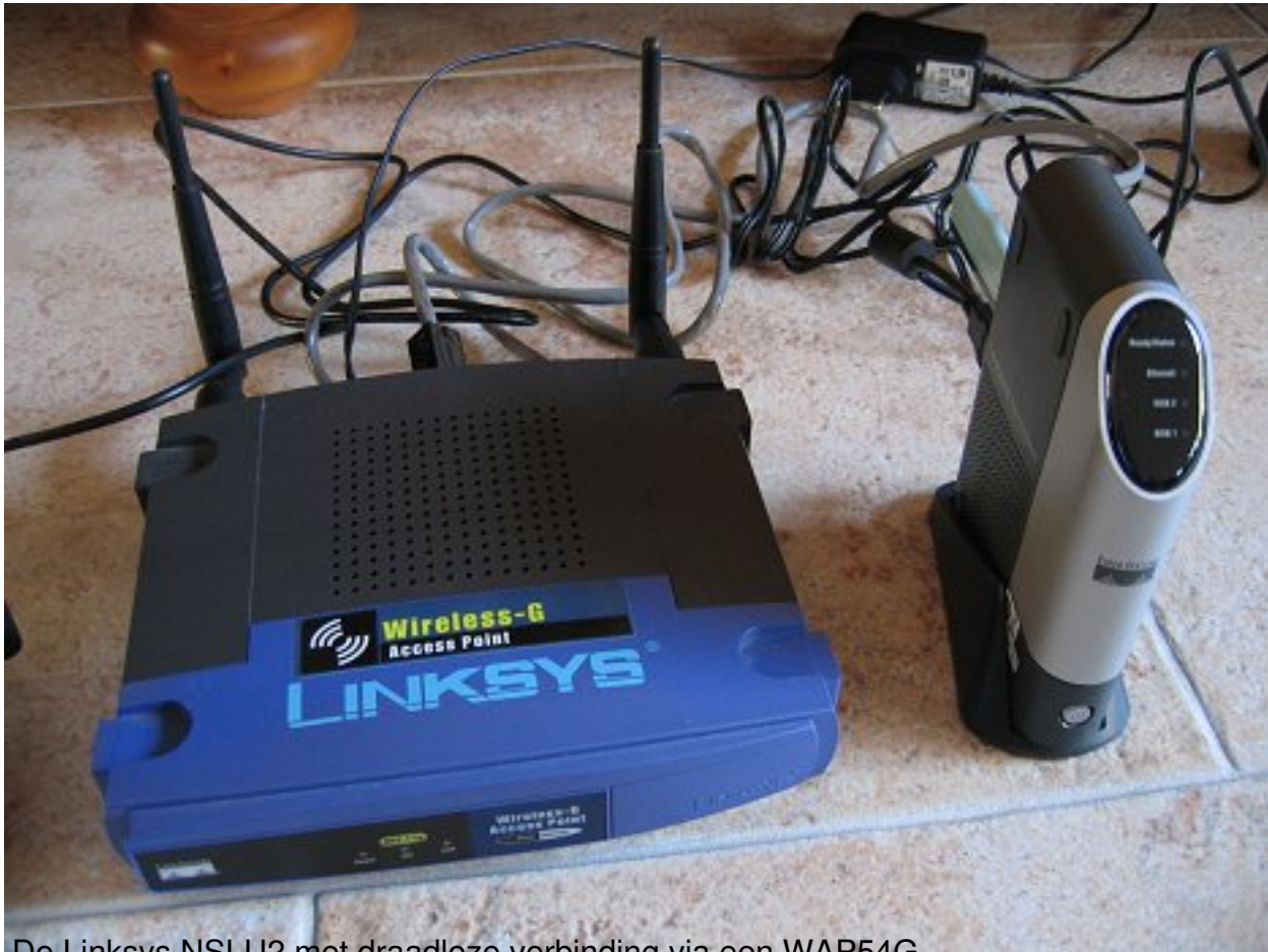
De Linksys NSLU2 met draadloze verbinding via een WAP54G
